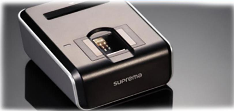
**BioMini Combo** se ha diseñado para proporcionar soluciones de seguridad de autenticación con dos factores para fines de autenticación. El escáner cuenta con el sensor óptico Slim que es el más reciente de Suprema y un área de captura de gran tamaño para facilitar la captura. La funcionalidad de lector de tarjetas inteligentes y la tecnología avanzada de detección de dedo vivo que mejora la seguridad hacen que BioMini Combo sea una plataforma segura para desarrolladores.
